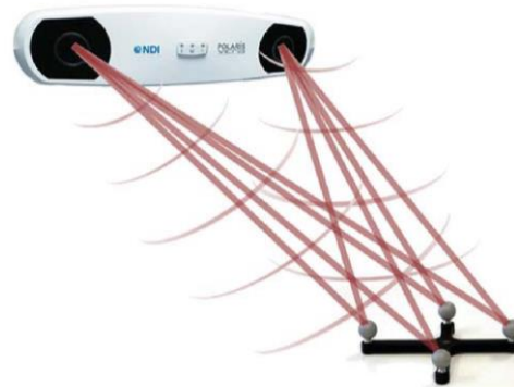
Abbildung 16: Arbeitsweise des stereo-optischen Infrarot-Kamerasystems (Product Catalog. PowerMAG View! Neuronavigation)
