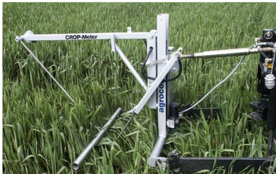
Abbildung 6: CROP-Meter Pendelsensor (Entwicklung ATB 2004)
