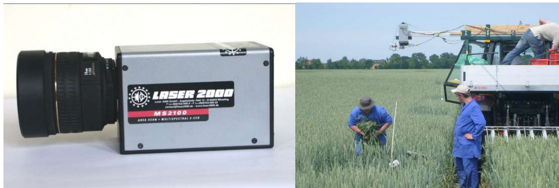
Abbildung 10: Multispektralkamera MS2100 mit Traktormontage
