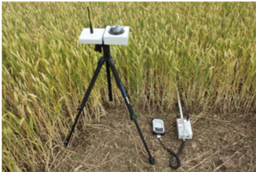
Abbildung 13: Sun Scan Messgerät für den LAI
