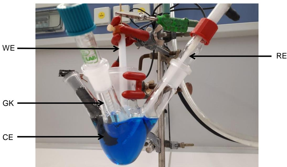
Abb. 19: Messstand zur elektrochemischen ZV-Charakterisierung mit Messzelle inklusive Vanadium(IV)-Elektrolytlösung, Arbeitselektrode WE, Gegenelektrode CE, Referenzelektrode RE und Gaseinleitungskapillare GK.
