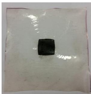
Abb. 18: Exemplarisch hergestellte MEE nach dem Pressvorgang bestehend aus einem Nafion<sup>®</sup> 115-Folienquadrat mit 5.5 cm Seitenlänge und der 1 cm<sup>2</sup> CNT-Beschichtung.
