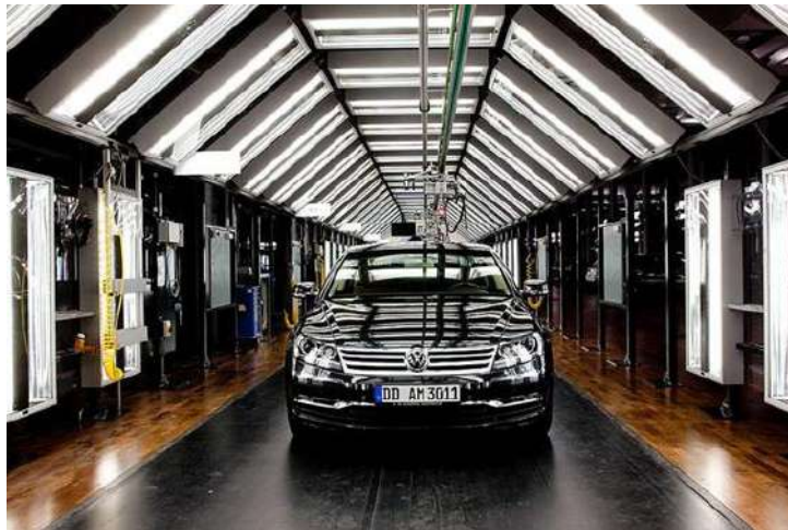
Abbildung 2.8: Optisch-zerstörungsfreie manuelle Inspektion in einem Lichttunnel. Quelle: Volkswagen AG
