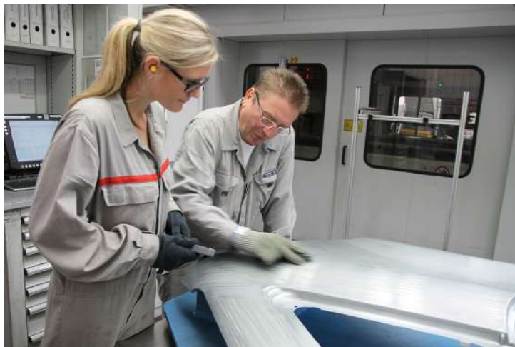
Abbildung 2.9: Optisch-zerstörende manuelle Inspektion mit einem Abziehstein. Quelle: Audi AG
