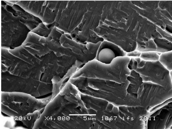
Bild 40: Karbideinschluss mit ca. 2,5 \mu\text{m} Durchmesser (Probe 1)
