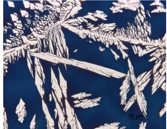
Schweißung mit 850°C Vorwärmung
