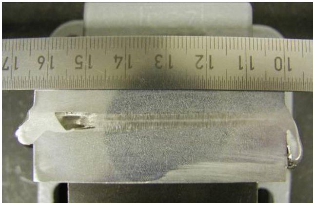
Bild 6: In PC-Position geschweißte EB-Naht mit großer Pore und seitlich herausgelauener Schmelze [3]
