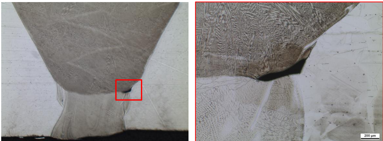
Bild 34: Bindefehler im Querschliff der MSG-CMT-Schweißnaht an alloy 600H durch ungenügendes Aufschmelzen von Einbrandkerben, die aus dem manuellen WIG-Schweißen der Wurzellage resultieren (Ätzmittel: ASTM 130)
