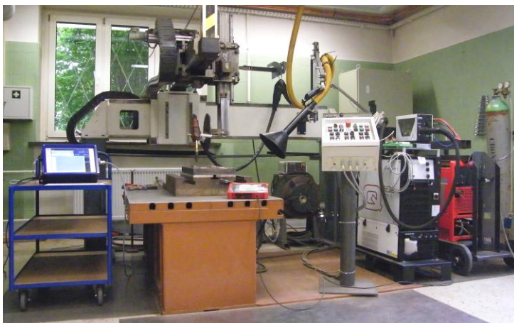
Bild 7: Versuchsstand zum MSG-Auftrag- und Verbindungsschweißen (links) und Messsystem WeldAnalyst der Fa. HKS Prozesstechnik (rechts)
