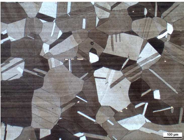
Bild 12: Mikrogefüge der vollaustenitischen Ni- und Fe-Basisgrundwerkstoffe im Anlieferungszustand (Ätzmittel: Bloech-Wedel II)
