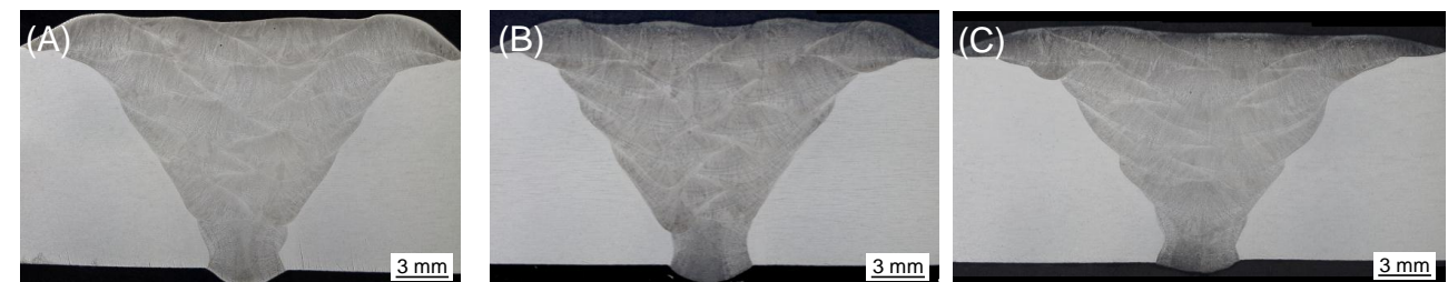
Bild 35: Makrogefüge der mit dem (A) CMT-, (B) Puls-Mix- und (C) ILB-Prozess gefertigten MSG-Schweißverbindungen an 16 bzw. 12 mm dicken Ni-Basisblechen (Ätzmittel: ASTM 130)
