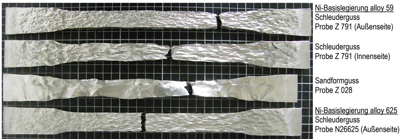
Bild 25: Flachzugproben ausgewählter Ni-Basis-Gussmaterialien.
