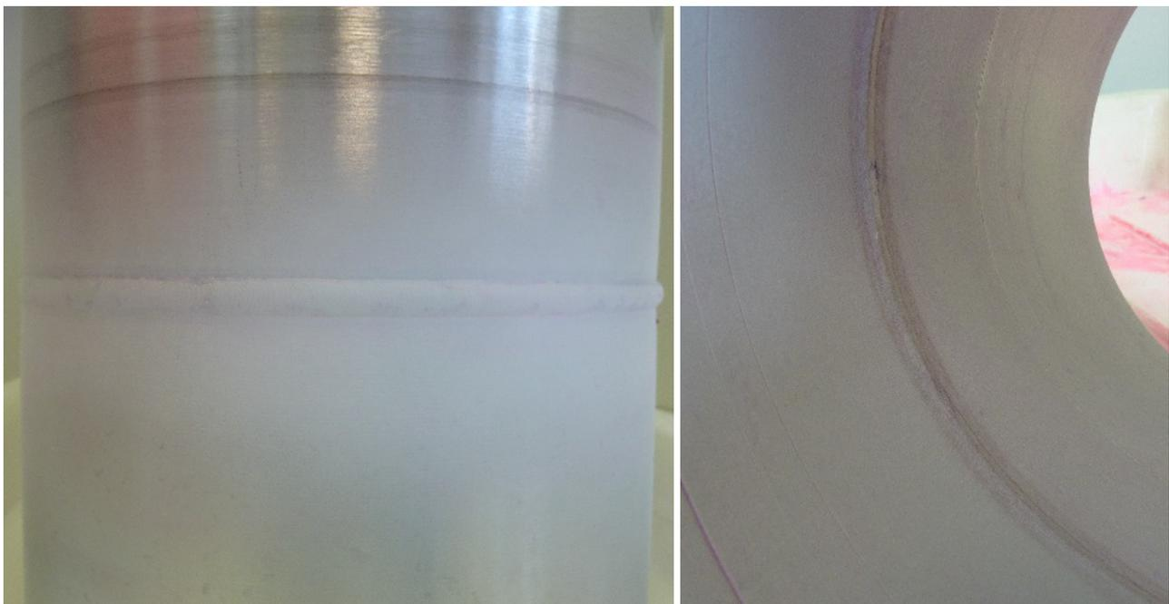
Bild 81: PT-Prüfung der Decklagen- und Wurzellagenseite der vWIG-Verifikationsschweißung am Schleudergussrohr aus alloy 617.
