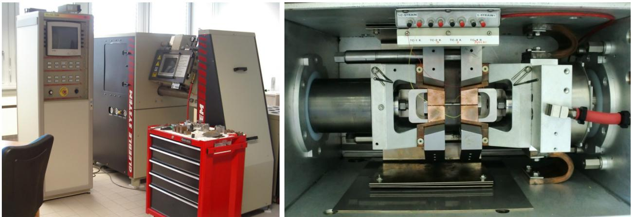
Bild 14: Gleeble<sup>®</sup> 3500-Prüfsystem am IWF, Universität Magdeburg (links) und Arbeitskammer mit in Kupferbacken eingespannter Rundzugprobe für den Heißzugversuch (rechts).
