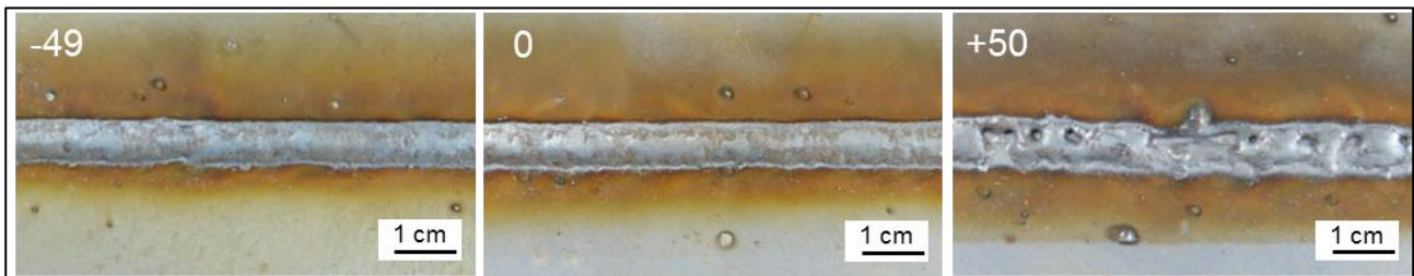
Abbildung 55: Veränderung des Nahtaussehens durch die Variation der AC-Dynamik ( CW , v_{Dr} = 3,5 m/min)
