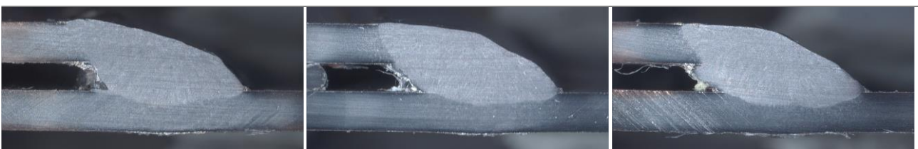
Abbildung 46: Querschliffe von Schweißverbindungen (Schutzgas M21) mit unterschiedlichen Blechkantenqualitäten (v.l.n.r. Naturkante, Laserschnittkante, geschliffene Kante)
