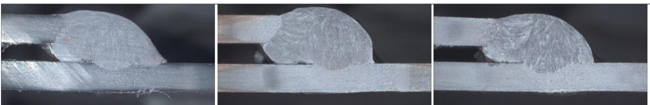
Abbildung 46: Querschliffe von Schweißverbindungen (Schutzgas M21) mit unterschiedlichen Blechkantenqualitäten (v.l.n.r. Naturkante, Laserschnittkante, geschliffene Kante)
