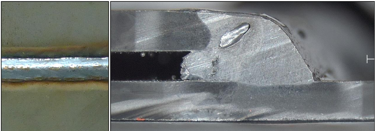
Abbildung 74: Naht und Querschliff einer CMT-Schweißung von 22MnB5+Z140 mit C1 und G4Si1 (Spalt 1 mm, Versatz = 0 mm)
