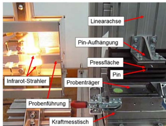
Abbildung 46: Durchdringungsversuchsstand (links), Maximale Durchdringungskraft in Abhängigkeit vom Pin-Spitzenwinkel – Exemplarischer Vergleich Simulation und Experiment (rechts)
