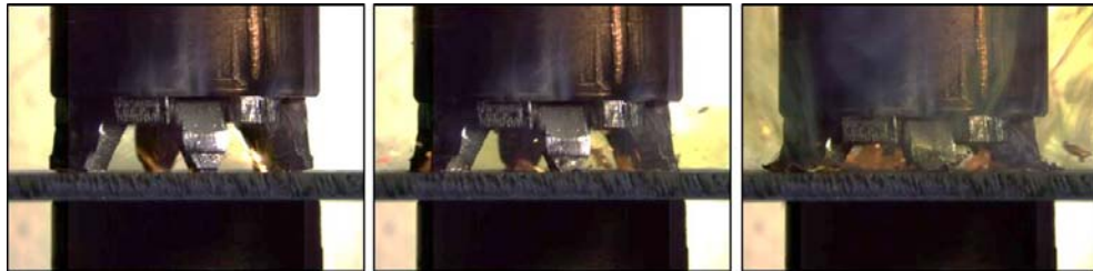
Abbildung 78: Hochgeschwindigkeitsaufnahmen des Schweißprozesses vom Sternelement
