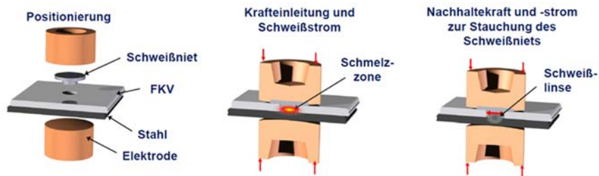
Abbildung 20: Widerstandselementschweißen durch modifizierten Schweißniet [Mes13b]
