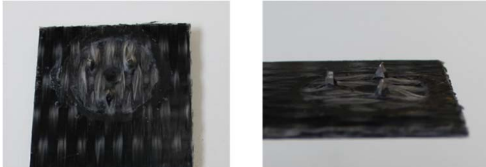
Abbildung 93: Durchdringungsergebnis mit Kombinationseinsatz (Silikoneinsatz mit Stift in der Mitte)
