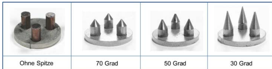
Abbildung 62: Variationen des Spitzenwinkels
