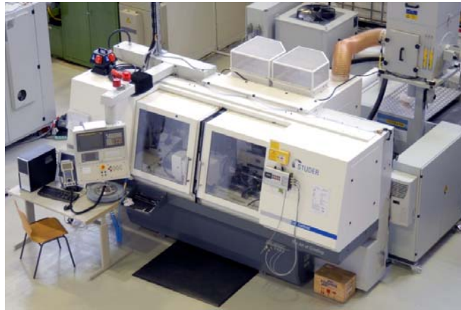
Abbildung 48: CNC-Universal-Rundscheifmaschine Studer S40cnc
