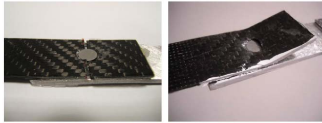
Abbildung 18: Strukturversagen beim Stanznieten durch Faserschädigung [Fra12]
