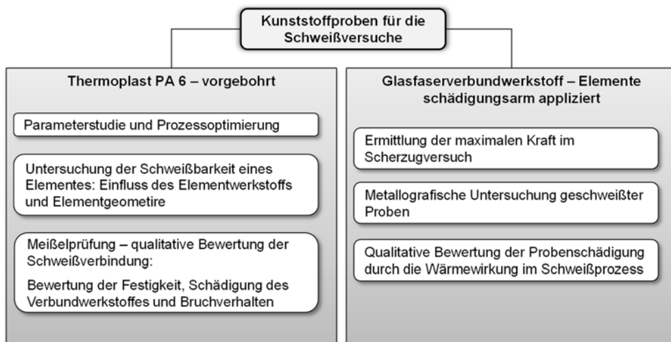
Abbildung 32: Schematische Aufteilung genutzter Deckblechen und Art der Elementapplikation
