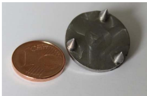
Abbildung 26: Konzept für Hilfsfügeteil im Größenvergleich (1. Prototyp)
