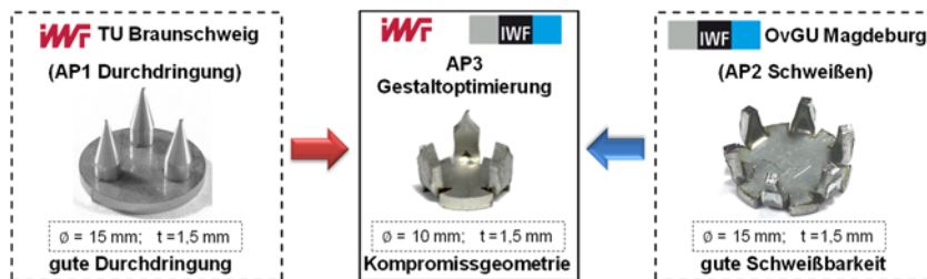
Abbildung 86: Ausgangsgeometrien für die Optimierung in AP3
