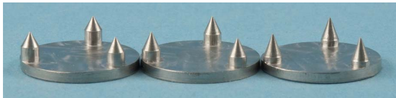
Abbildung 52: Gefräste Prototypen mit unterschiedlichen Spitzenwinkeln (Kopfdurchmesser 20 mm)
