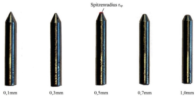
Abbildung 50: Hergestellte Pins mit variiertem Spitzenradius r_{sp} ( \alpha = 50^\circ , d_p = 3 \text{ mm} )
