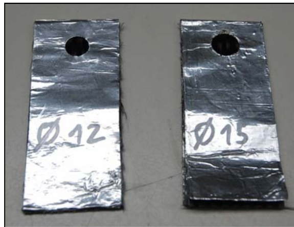
Abbildung 54: Durchdringungsproben mit Maskierungsfolien für unterschiedliche Aufschmelzdurchmesser
