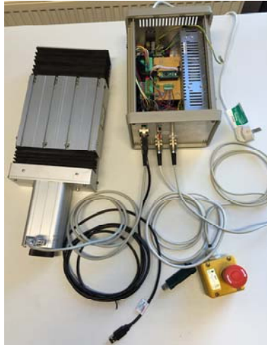
Abbildung 45: Im Projekt gebaute programmierbare Steuereinheit mit angeschlossener Linearachse
