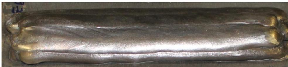
Abbildung 30: UP-Auftragschweißgutblock, der mit der Drahtcharge VII und dem Schweißpulver SP 3 hergestellt wurde
