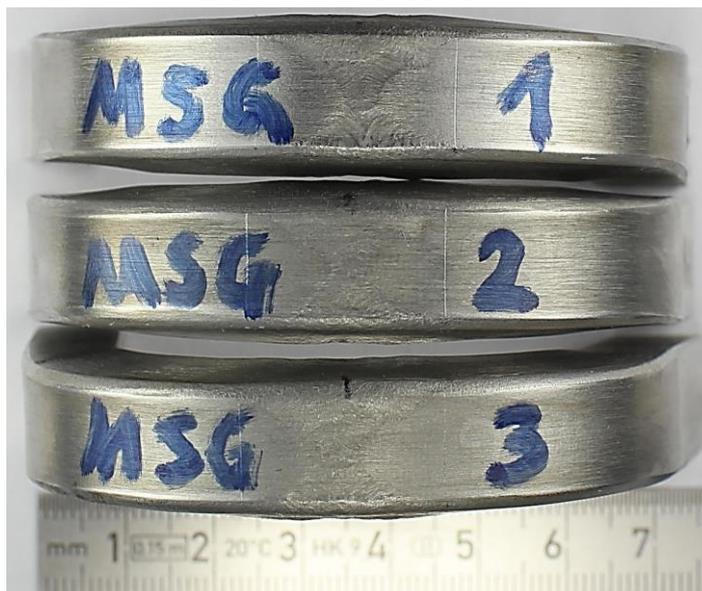
Abbildung 67: Seitenbiegeproben der MSG-Schweißverbindung mit einer durchschnittlichen Nahtdehnung von 28 %
