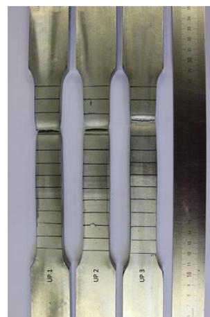
Abbildung 77: Querzugproben sowie Dehngrenze, Zugfestigkeit und Bruchdehnung der UP-Verbindungsschweißung
