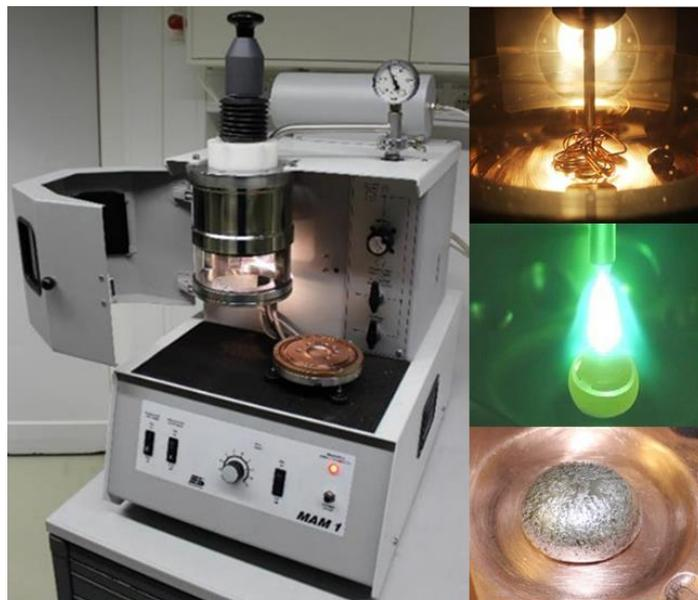
Abbildung 12: Lichtbogenofen (links) und bestückter Tiegel, Umschmelzung sowie Button nach der Umschmelzung (rechts von oben nach unten)
