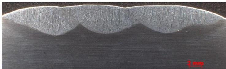
Abbildung 37: Makroschliffbild des mit der Grundwerkstoffcharge G, der Zusatzwerkstoffcharge IX und dem Schweißpulver SP 3 hergestellten einlagigen UP-Auftragschweißguts
