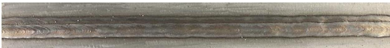
Abbildung 74: Nahtaussehen der UP-Verbindungsschweißung
