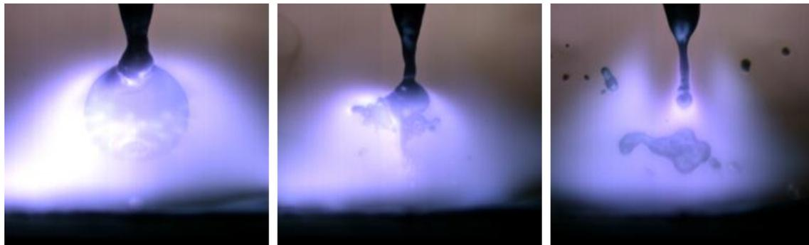
Abbildung 22: Aufblähung und Zerplatzen eines Tropfens während des Schweißprozesses
