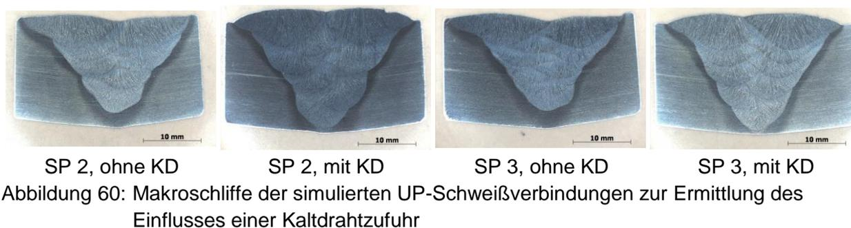
Auch mit dem UP-Prozess wurden sehr geringe und annähernd gleiche Porenanteile (0,02 - 0,04 %) sowohl mit als auch ohne Kaltdrahtzufuhr erzielt. Eine Beeinflussung des Porenanteils des Schweißgutes durch eine zusätzliche Kaltdrahtzufuhr wurde nicht detektiert, vgl. Abbildung 61. Auch die Sauerstoff- und Stickstoffgehalte der UP-Schweißungen werden durch die Kaltdrahtzufuhr nicht beeinflusst. Sie sind für alle Schweißgüter annähernd gleich, vgl. Abbildung 62.
