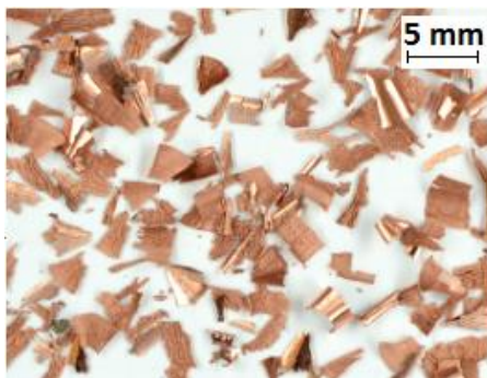
Abbildung 33: Spanformen der e4-Elektrode bei R40 mit 620 \text{ min}^{-1} und 1,2 kN [62, S.70]
