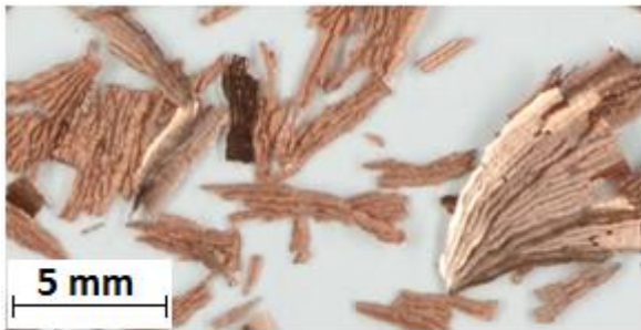
Abbildung 34: Nahaufnahme der Späne von e4 bei R15 mit 330 \text{ min}^{-1} und 1 \text{ kN} , [62, S.70]
