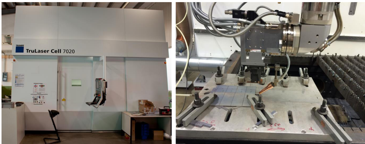
Bild 17: 3D-Laserbearbeitungszentrum und Versuchsaufbau zum Laserstrahlschweißen Figure 17: 3D laser processing centre and experimental setup for laser welding
