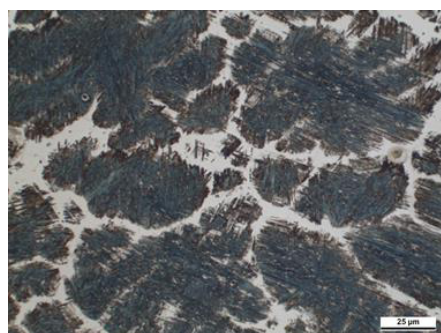
Bild 39: Ergebnisse der EDX-Analysen am Beispiel eines Mischschweißgutes aus FeMn-I + HC340LA mit \Phi_{\text{HC340LA}} = 50\% . Lichtmikroskopische Aufnahme des Gefüges zum Vergleich (unten links). Ätzung: Klemm I
