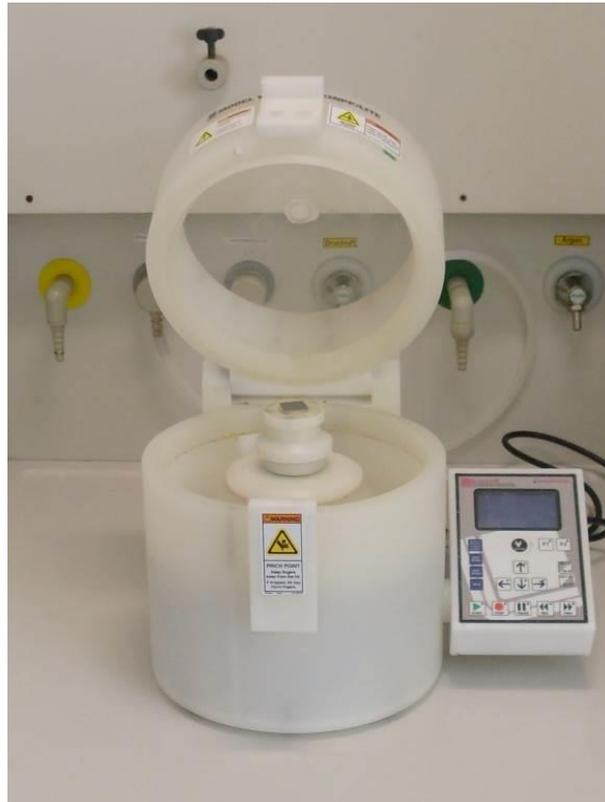
**Abb. 2.1:** Rotationsbeschichter („Spin Coater“) mit Substrat.
