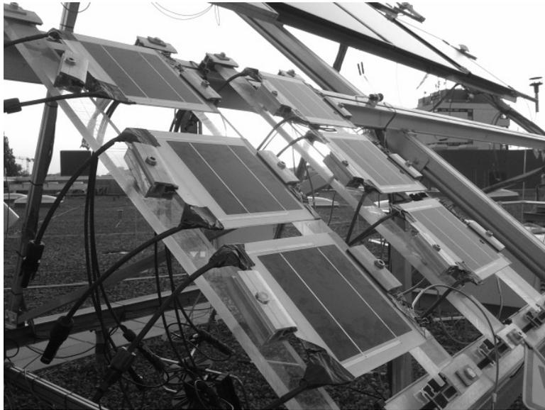
Abbildung 4.7.: Halterung der Probenaufnahme auf dem Dachlabor des PI Berlin
