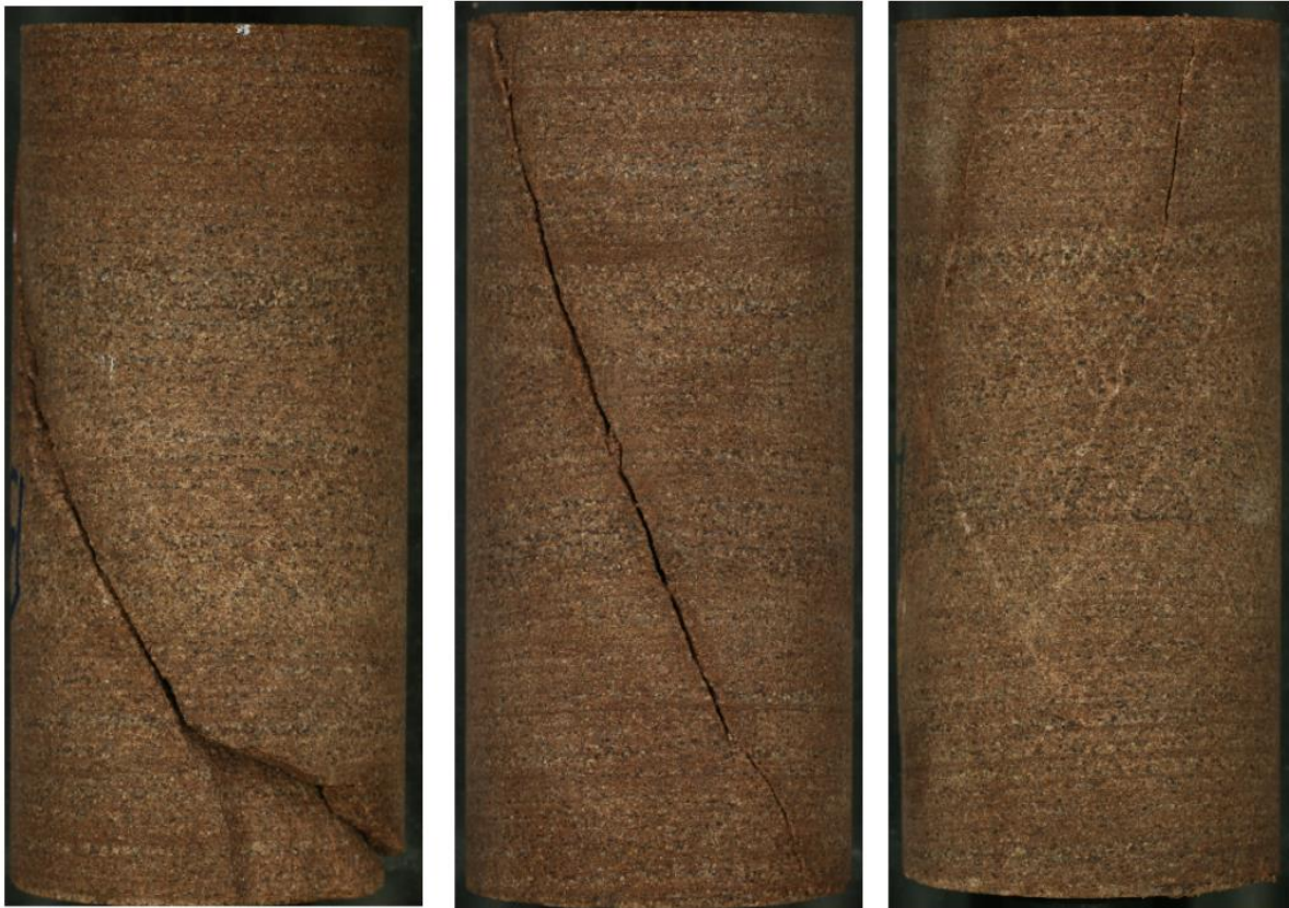
Abb. 1. Beispiele für unterschiedlich entwickelte Rissbildungen anhand von senkrecht zur Schichtung gebohrten Prüfkörpern aus dem Rotliegend (70 mm x 140 mm). Von links nach rechts: Verkeilte, isolierte und konjugierte Scherfläche.
