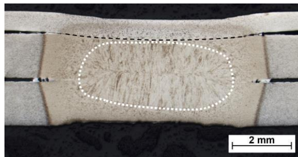
Bild 1: Dreiblech Schweißverbindung von partiellgehärteten 22MnB5 mit einem dünnen Außenblech und mangelhafter Linseneindringtiefe in das dünne Blech.
