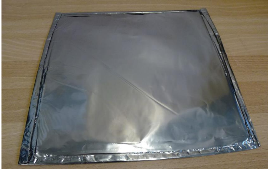
Bild 22: unbeschichteter 22MnB5 in einer Härtefolie nach dem Presshärten
