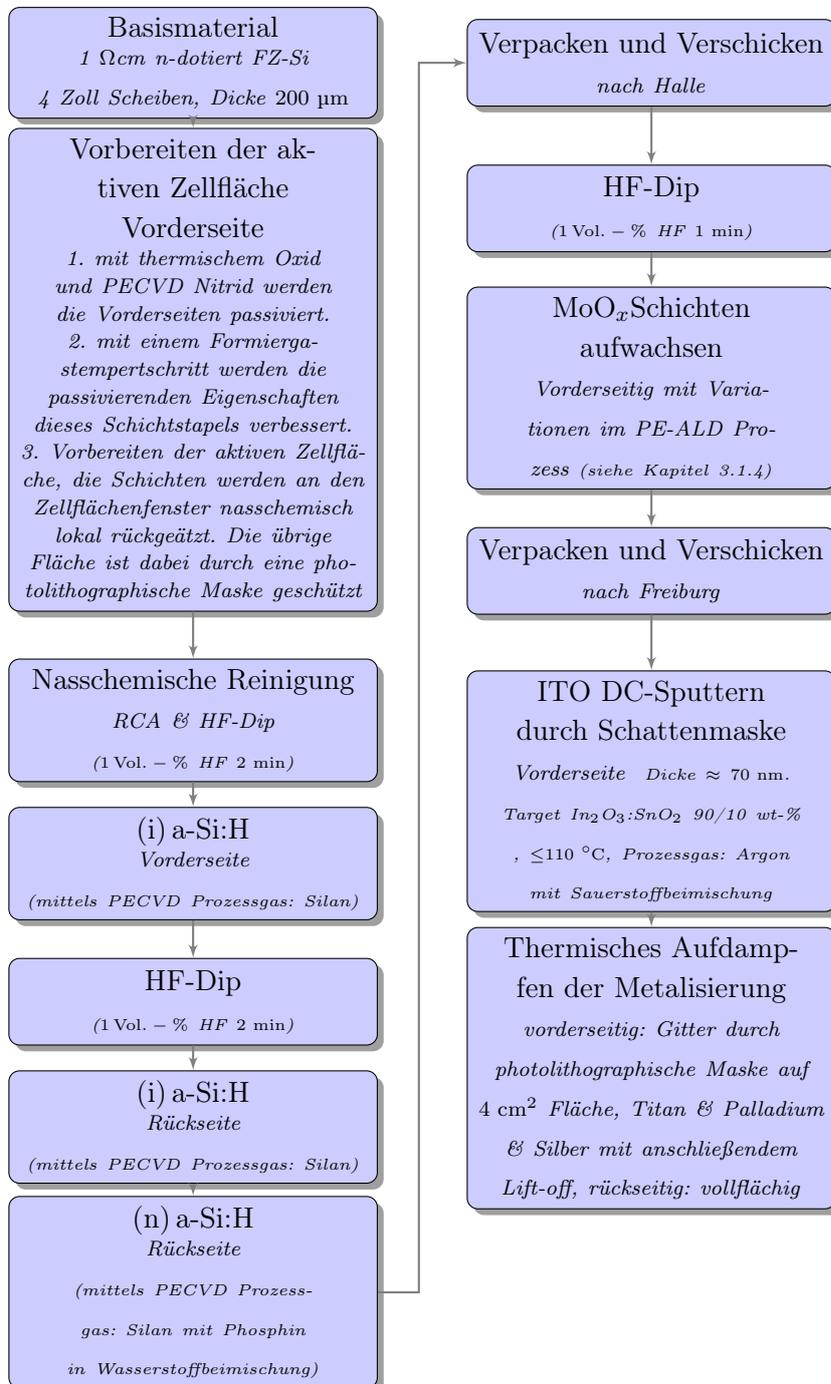
**Abbildung 3.14:** Schematische Abfolge der verwendeten Prozessschritte zur Zellherstellung von Zellen mit  $2 \times 2 \text{ cm}^2$  Zellfläche am ISE (genaue Details zu dem verwendeten Teilprozessen finden sich im Kapitel 3.1.1 Process flow in der Doktorarbeit von Herrn Bivour [16]). Verschieden PE-ALD  $\text{MoO}_x$  Schichten wurden mit diesem Prozess getestet.
