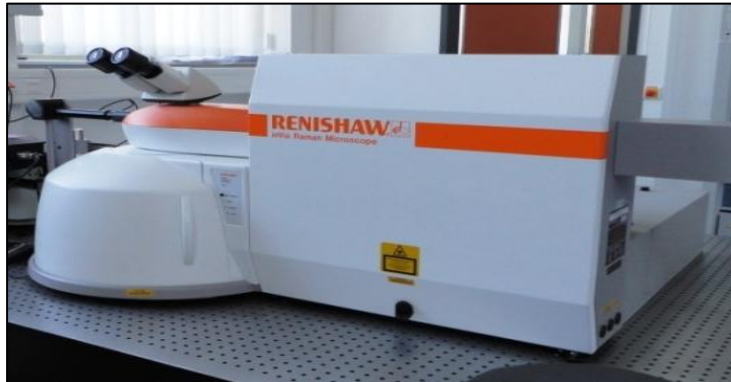
Abbildung 55: oben: vereinfachtes Funktionsprinzip eines Raman-Spektrometers, verändert nach: http://www.see.ed.ac.uk/cbee/Raman2.html , aufgerufen am 3.5.15 und KOUKETSU et al. (2014). unten: Renishaw inVia Raman Microscope des Fachbereichs Technische Chemie erneuerbarer Energien der Martin-Luther-Universität Halle-Wittenberg (Foto: STEIMECKE 2012, unveröff.)
