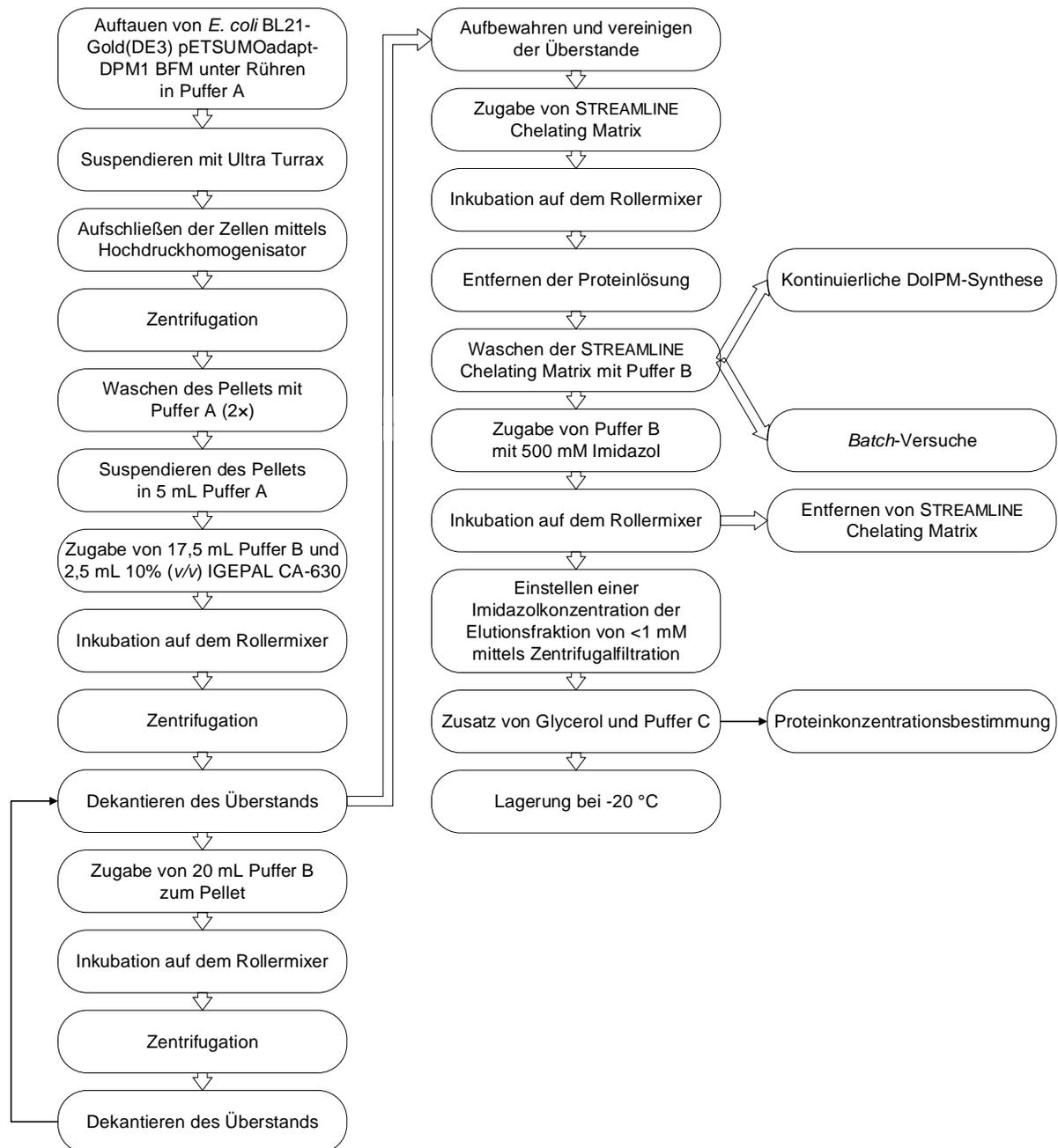
Abb. 2.1 Schematischer Ablauf der Isolierung von His<sub>6</sub>-SUMO-Dpm1 und Immobilisierung an STREAMLINE Chelating (GE) von His<sub>6</sub>-SUMO-Dpm1. Details im Text.
