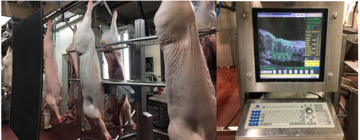
Abbildung 30: Installation des CSB-Image-Meaters und Beispiel einer Messwertaufnahme in Spanien (eigene Aufnahme)
