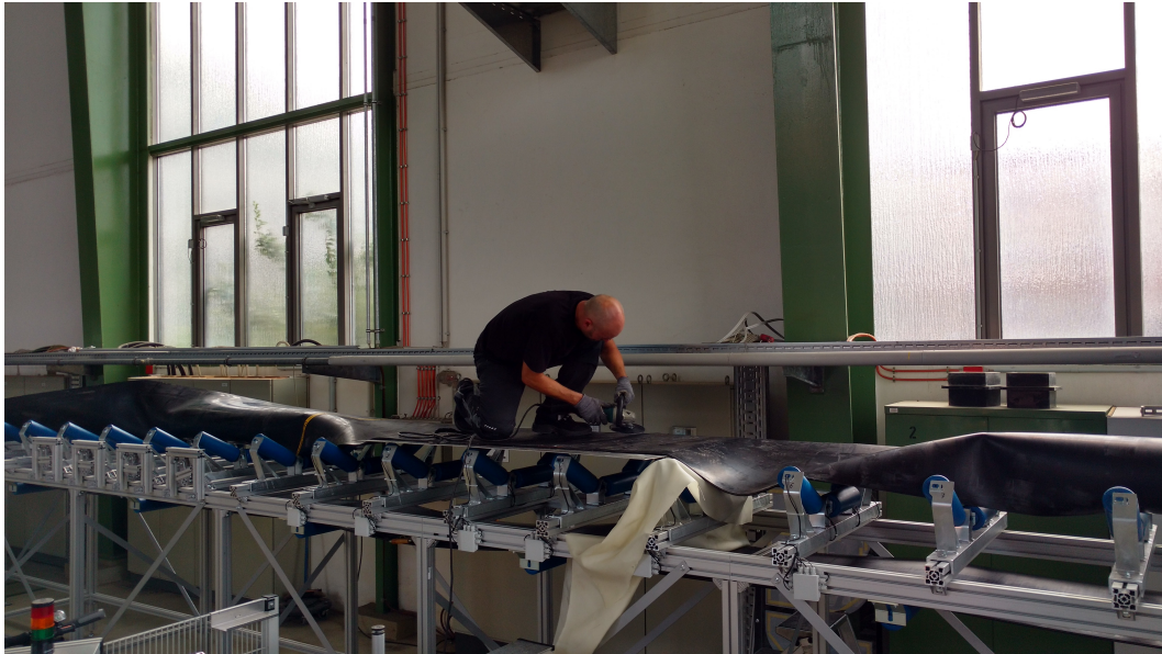
Abb. 6.21: Gurtwende bei der Verbindungsvorbereitung mit sehr geringen Rückstellmomenten
