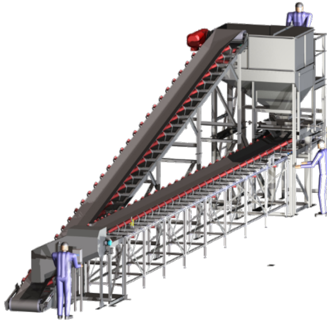
Abb. 8.2: Versuchsstand mit Rückförderer als geschlossener Materialkreislauf [121]
