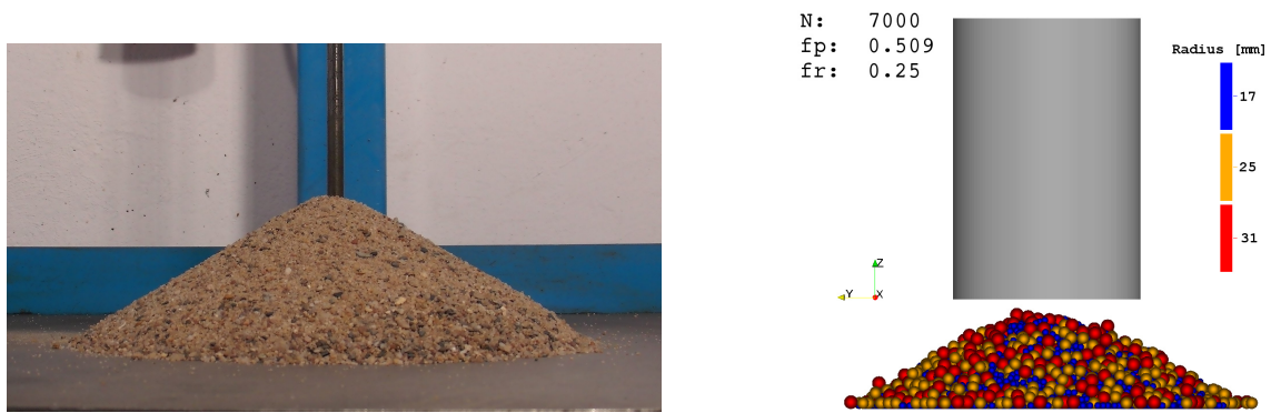
Abb. 3.15: Versuchsergebnisse für Mainsand (links) und die Ergebnisse der übereinstimmenden Kalibrierungsuntersuchung für eine festgelegte Korngrößenverteilung
