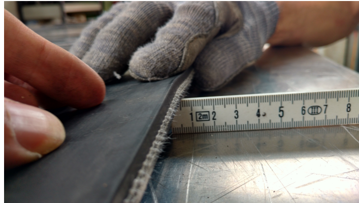
Abb. 8.10: Seitlicher Versatz an der Fügestelle durch unterschiedlich breite Gurtenden
