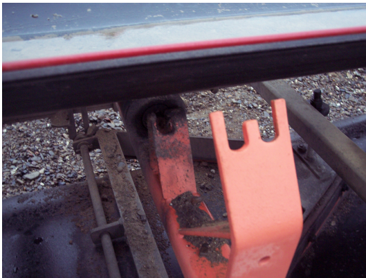
Abb. 3.7: Mögliche Schrägstellung der äußeren Rollen und Sturz Stellen
