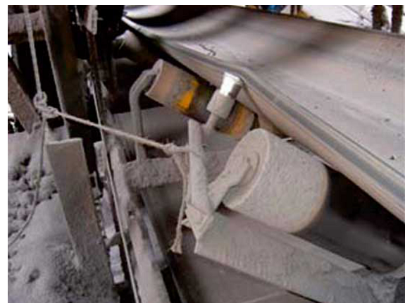
Abb. 3.32: Automatische Gurtlenkeinrichtung mit übersprungenem Gurt [127]
