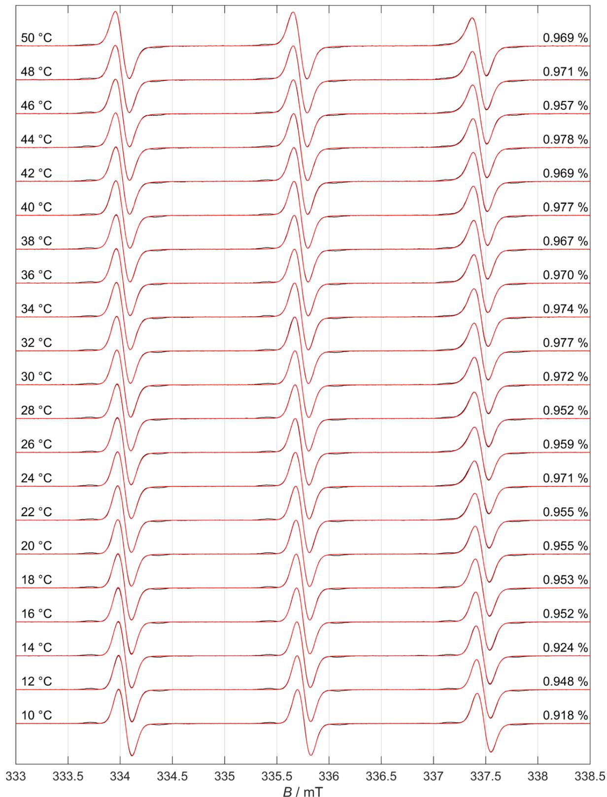
**Abbildung 8.9:** Experimentell gemessene CW-EPR-Spektren (schwarz) zusammen mit ihren jeweiligen Simulationen (rot) bei einer Polymerkonzentration von  $15 \text{ mg mL}^{-1}$   $\text{P}(\text{Et}_{33}\text{-co-}n\text{Bu}_{76})$  und  $0,2 \text{ mM}$  TEMPO in DPBS-Puffer mit den zugehörigen Temperaturen (links) und RMSD-Werten (rechts).<sup>60</sup>
