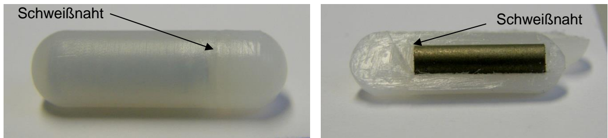
Abbildung 5 Links: Kapsel nach dem Verschweißen, rechts: aufgeschnittene Kapsel [23]
