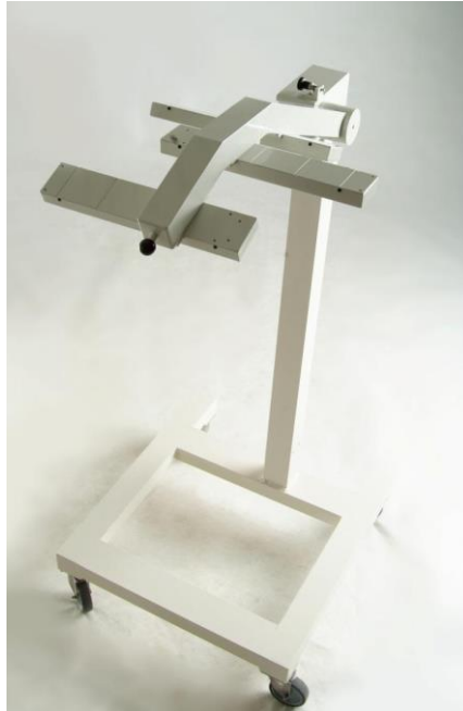
Abbildung 1 Detektionsarm des 3D-Magma-Geräts der Firma Matesy [19]
