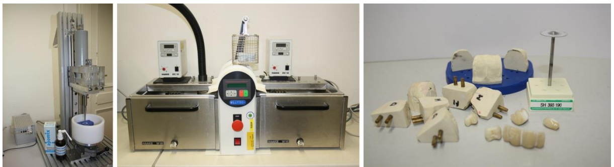
Abb. 24 A: Gängelmaschine mit Speichelbad, B: Thermozyklriergerät, C: zersägtes Arbeitsmodell
