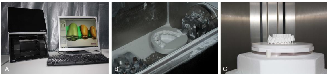
Abb. 12 A: Scanner 3Shape D700, B: Fräseinheit 4xT Desktop, C: Sinterofen Organic Heat
