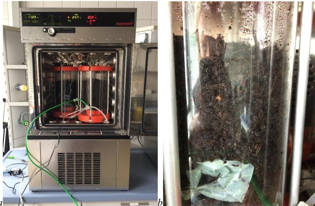
Abbildung 8: Aufbau Versuch Bioabbaubarkeit. a) Messzellen im Wärmeschrank. b) Mit Kompost, Sporen und Biokunststoffolie befüllte Messzelle. (Eigene Bilder)
