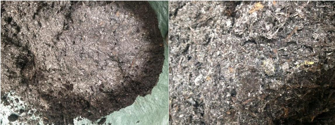
Abbildung 15: Trockener, verpilzter Kern im Reaktorinneren
