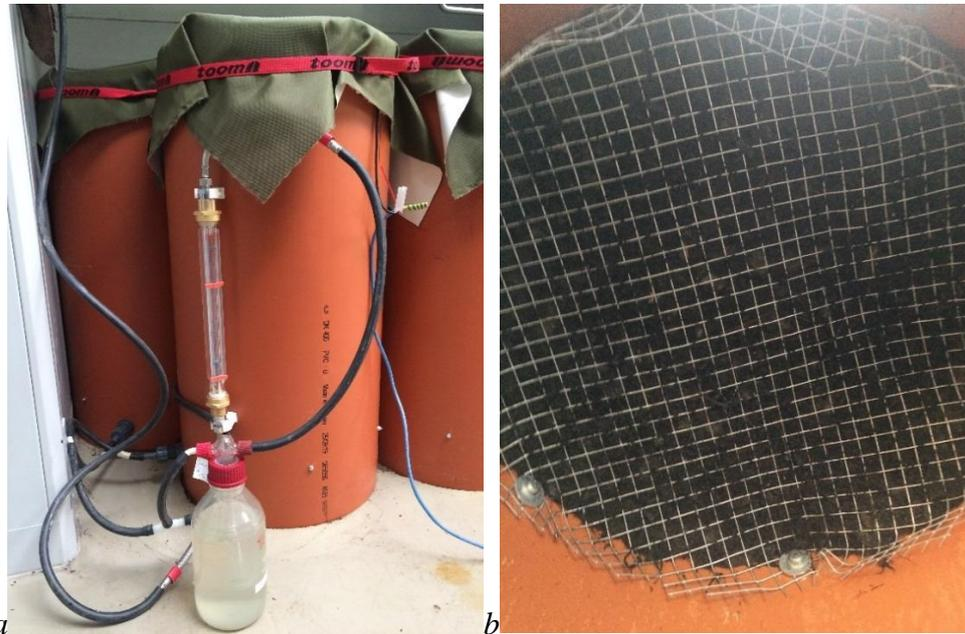
Abbildung 7: Aufbau der Rottereaktoren. a) Abdeckung und Belüftung. b) Kompost lagert auf Volieren-gewebe. (Eigene Bilder)
