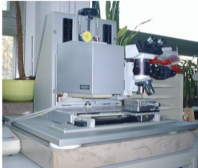
Abb. 7: Mikrohärteprüfgerät Fischerscope H100c (Fa. Helmut Fischer GmbH, Sindelfingen, Deutschland)
