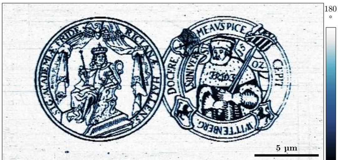
**Abb. G.4.:** PFM-Phasenbild (DART) des Siegels der Martin-Luther-Universität Halle-Wittenberg als ferroelektrische Domäne auf einer  $PbZr_{0,2}Ti_{0,8}O_3$ -Probe (aufgenommen in Zusammenarbeit mit Er-Jia Guo).
