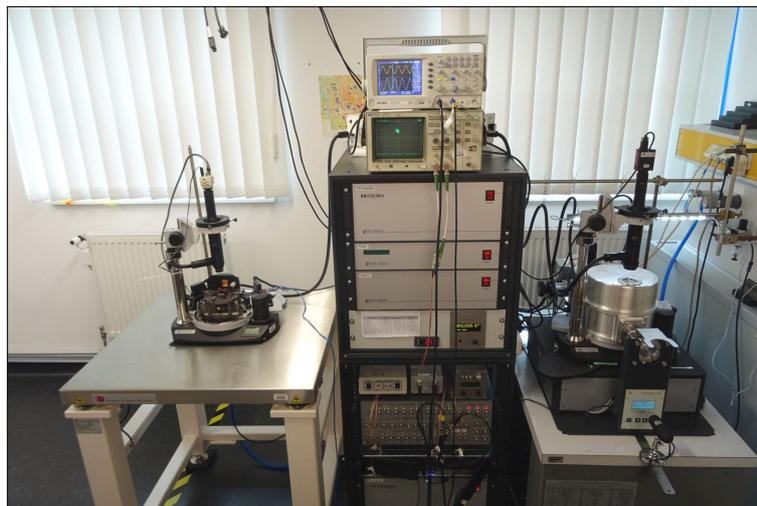
**Abb. A.3.:** Aufbau des NTEGRA-Systems, links steht das Luft-AFM und rechts das Vakuum-Kühlsystem.
