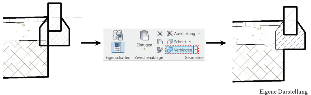
Abb. 107: Parametrisches Verbinden der überschneidenden Geometrien des Belagaufbaus und des Fundaments
