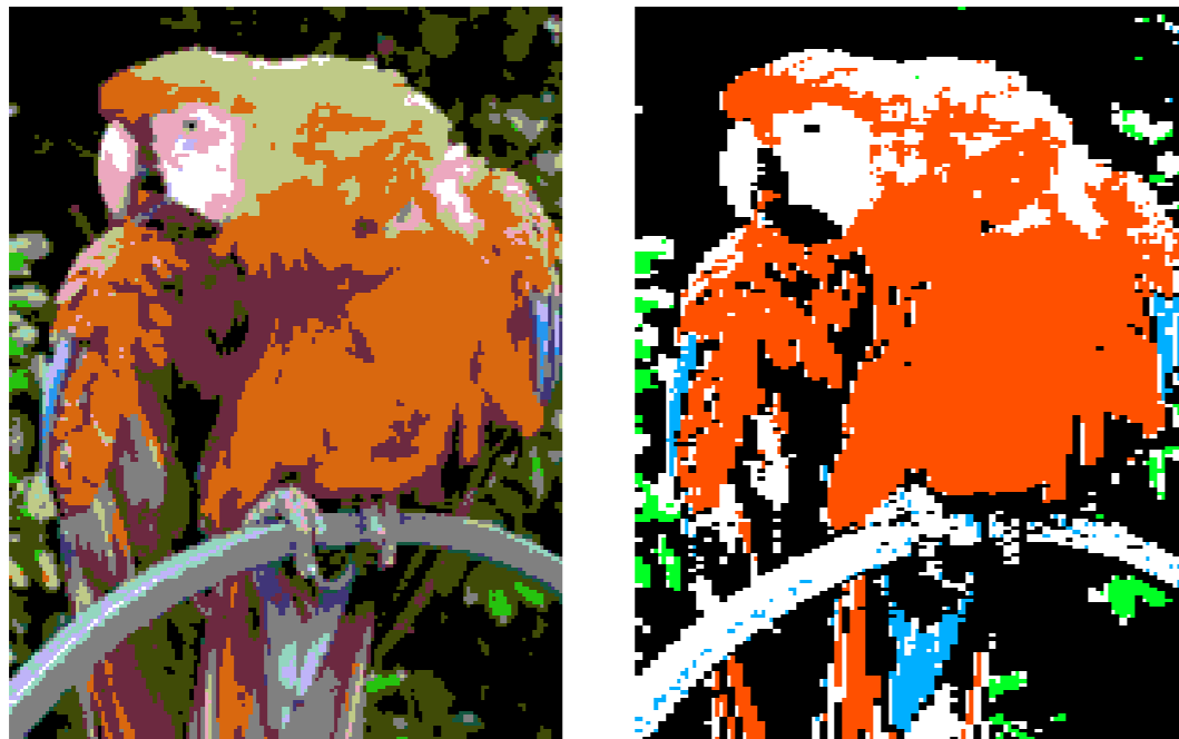
Abb. 20: Vergleich der Farbdarstellung des Apple II im niedrig- und hochauflösenden Modus.
