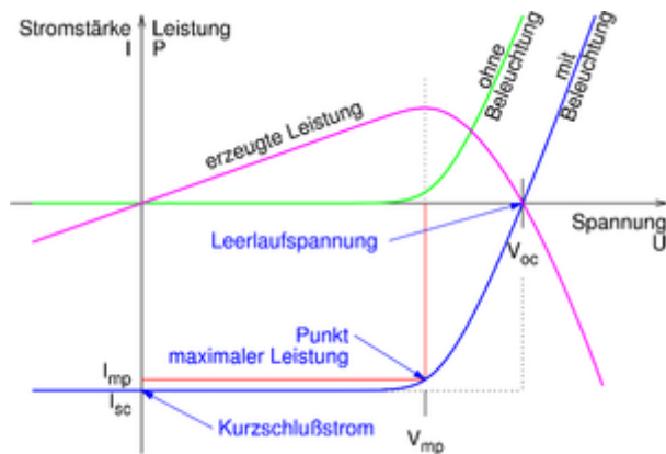
Abbildung 3: Strom-Spannungs-Kennlinien einer Solarzelle (7) .
