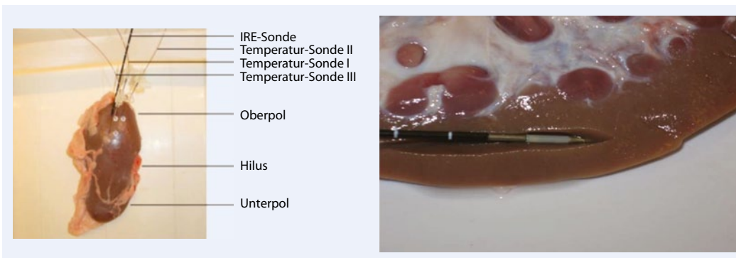
Abb. 3 ◀ Anordnung der Messsonden und Mikrokorporationselektrode (links), Markierung des Elektrodenkanals für die histologische Aufarbeitung (rechts)
