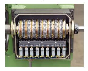
Bild 13: Nockenschaltwerk [12]
