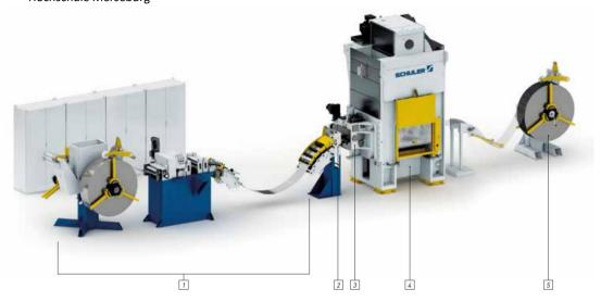
Bild 11: Platinen-Schneid-Linie aus SCHULER [11], 1-Bandanlage, 2-Banddickenmessgerät, 3-Präzisionsvorschub, 4-Blankmaster Presse, 5-Aufwickelhaspel
