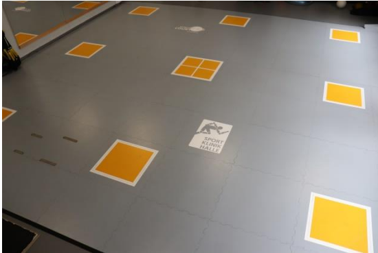
Abb. 12: SpeedCourt Testfläche mit den in orange markierten Sensorfeldern
