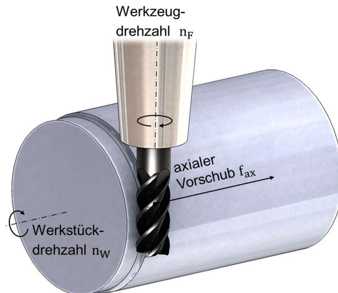
Abbildung 11: Kinematische Verhältnisse beim tangentialen Drehfräsen
