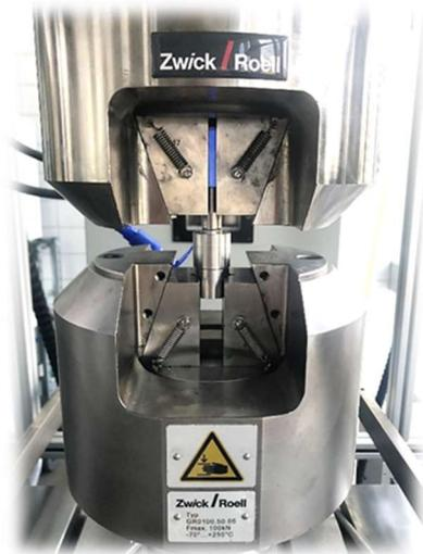
Abbildung 29: Servohydraulische Schwingprüfmaschine Zwick/Röll
