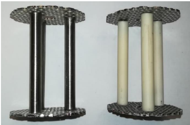
Abbildung 4-42: Foto vom Aufbau des internen Wärmetauschers und einem Vergleichsmodell mit geringer Wärmeleitung.
