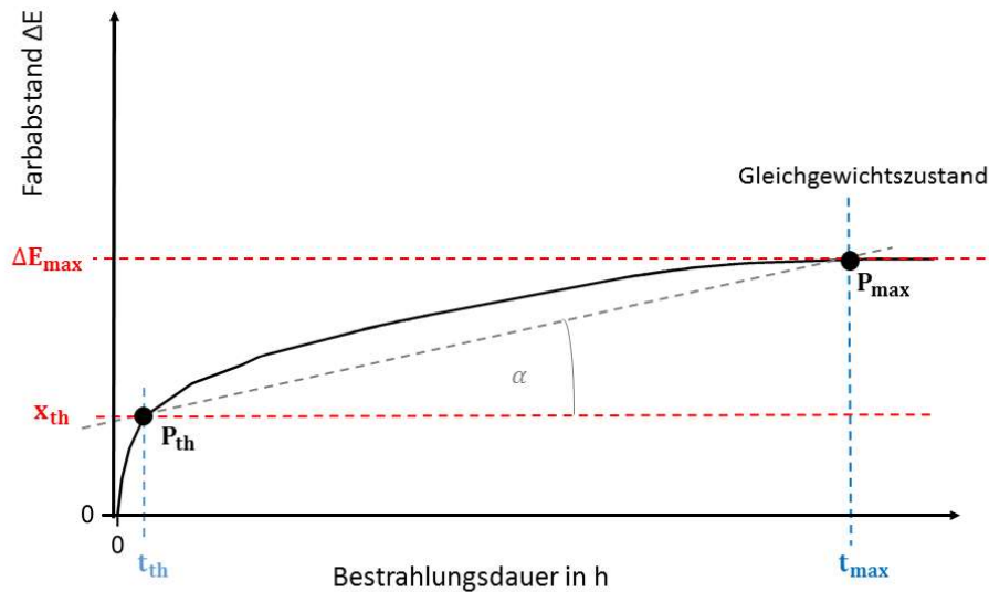
Abbildung 31, Ideale Farbabstandskurve für mineralische Buntpigmente in Abhängigkeit von der Bestrahlungsdauer mit den für die Kategorisierung der optischen Strahlungsbeständigkeit charakteristischen Punkten P_{th} ( t_{th} , x_{th} ) und P_{max} ( t_{max} , \Delta E_{max} ) sowie dem Gradienten \alpha .
