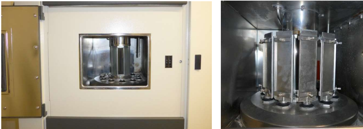
Abbildung 22, (li.) Sicht auf die Bestrahlungskammer des Xenontests der Fachhochschule Erfurt mit der in der Mitte befindlichen Xenondampflampe und (re.) der um die Lampe angebrachten Probenhalter.
