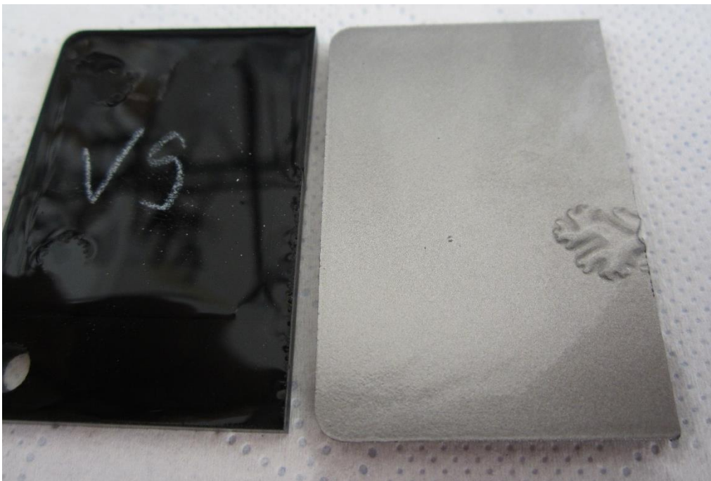
Abb. 34 Ablation des Klarlackes der Beschichtungsrezeptur R1702+20 (V9) vom Primer bei einer Quellung im Ethanol
