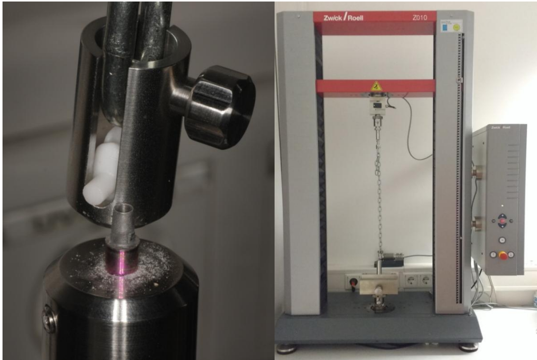
Abb. 11: links Probe nach dem Abzugsversuch; rechts gespannte Abzugsvorrichtung in der Universalprüfmaschine
