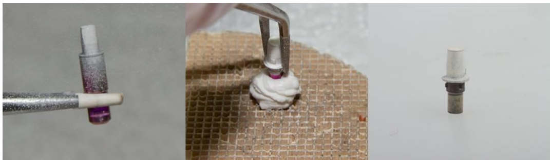
Abb. 6: Aufsprühen des Keramiksprays (links), Fixierung auf einem Brenntäger (mittig), Zustand nach dem Sinterbrand (rechts)
