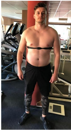
Abb. 16 – H3 Herzfrequenz-Sensor und dazugehörige Befestigung mittels ‚Wearlink‘
