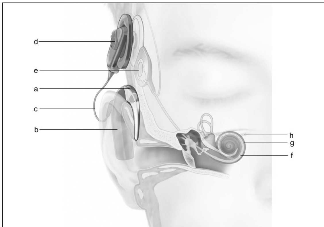
Abbildung 5: Exemplarische Darstellung des Aufbaus eines Cochlea-Implantates hier am Beispiel des Nucleus Prozessors der Firma Cochlear®. Das System besteht aus a) einem Mikrofon, b) dem Sprachprozessor, c) einem Kabel welches die Verbindung zur d) Sendespule herstellt. Dieses überträgt das Signal transkutan via Induktion auf das e) Implantat. Das Implantat leitet die Informationen über den f) Elektrodenträger, welcher in der g) Cochlea liegt und überträgt elektrische Impulse auf den h) N. cochlearis. (modifiziert nach Cochlear™)
