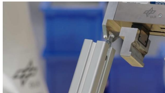
Abbildung 19: Stecken von Nutenstein[12]
