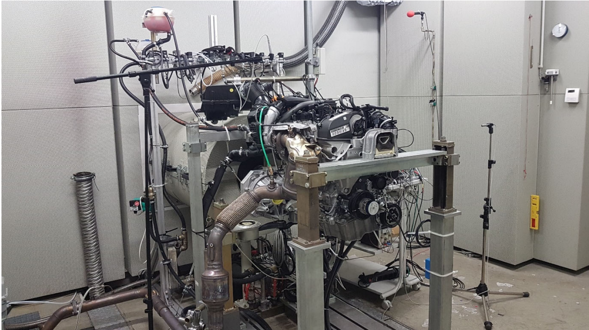
Abbildung 5: Versuchsaufbau des Ottomotors am Akustikprüfstand
