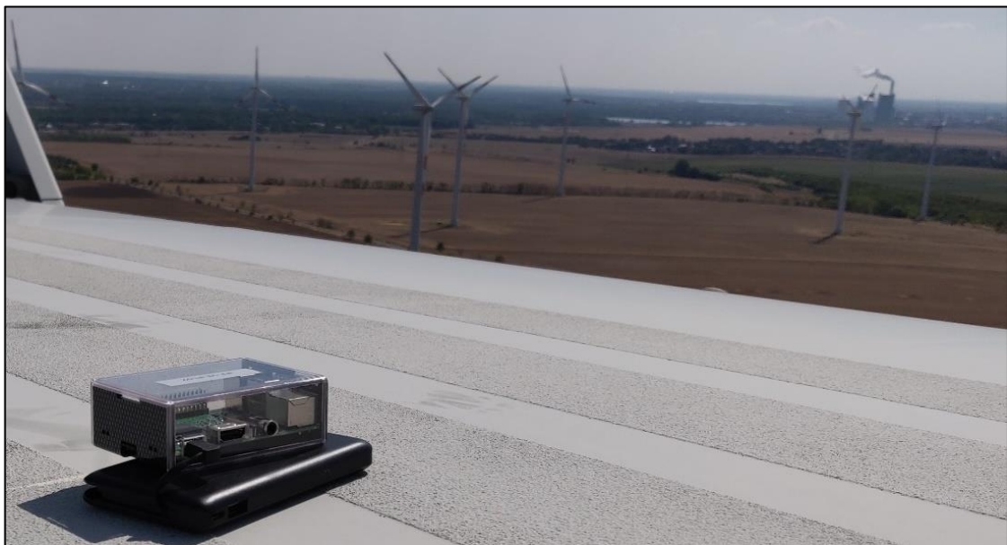
Abbildung 16: „Pocket-Assist“ (Einplatinencomputer und Powerbank) auf dem Dach einer Windenergieanlage (eigene Darstellung)
