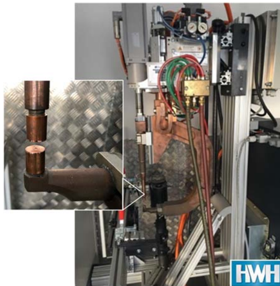
Abbildung 48: Servoelektrische Schweißzange der Firma Düring mit 1kHz MFDC Inverter und Genius Schweißsteuerung der Firma Harms & Wende
