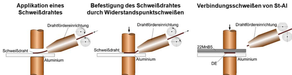
Abbildung 3: Zuführungsvariante des Drahtelementes für die neuartige Füge-technologie
