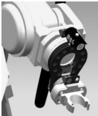
Figure 12 CCD-Modul des Roboter-Sichtführungssystems
