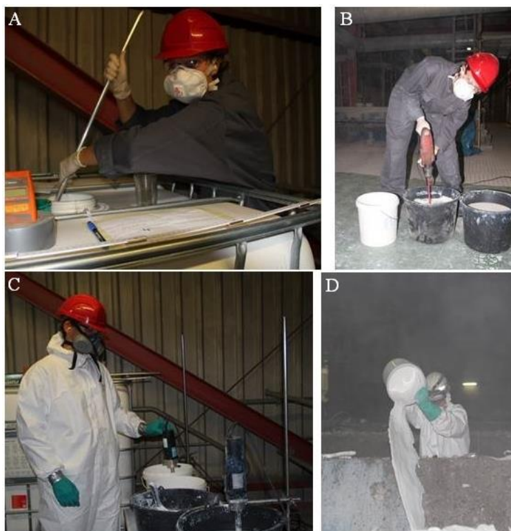
Abbildung 2: Herstellung der 35 %igen BaSO 4 -Suspension; praktische Arbeiten: Sarah Thomas, Kollegen der RWTH Aachen und MVA, Fotos: F. Glahn
