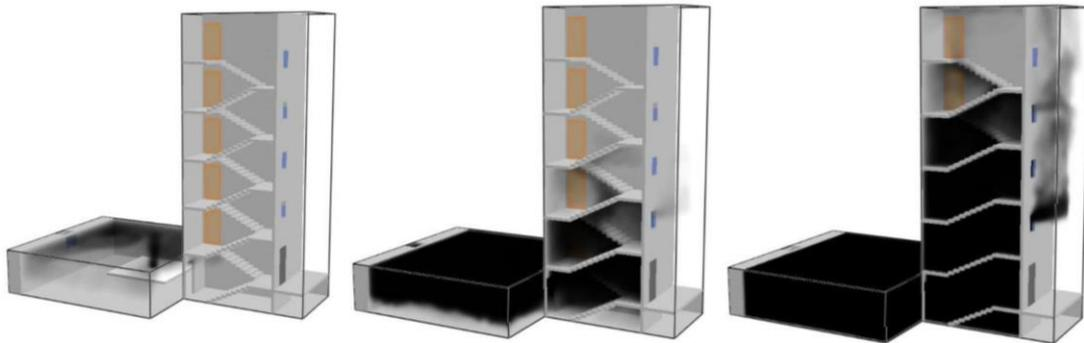
Abbildung 3: Rauchausbreitung im Brand- und Treppenraum. Dargestellt ist die Brand- und Rauchgassimulation 1 Minute nach Brandausbruch (links), 3 Minuten nach Brandausbruch (mittig) und 5 Minuten nach Brandausbruch (rechts).
