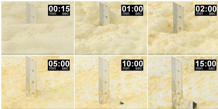
Abbildung 50: Zerstörung der CAF-Schicht bei direkter Applikation von ABC-Löschpulver
