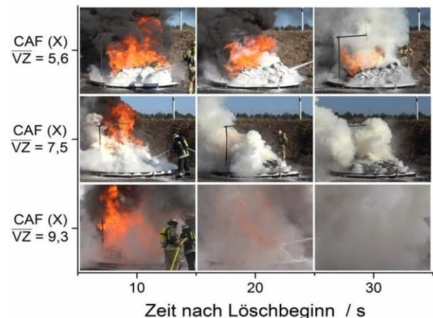
Abbildung 47: Momentaufnahmen aus den Videoaufzeichnungen während der ersten 30 s der CAF-Löschvorgänge mit unterschiedlichen Verschäumungszahlen
