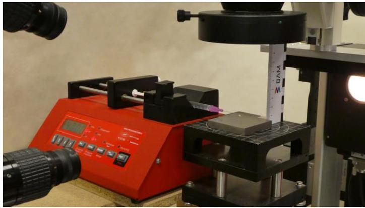
Abbildung 5: Versuchsaufbau der Kontaktwinkelmessungen
