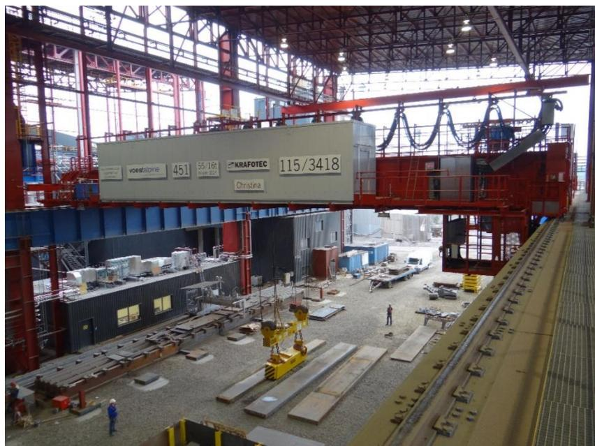
**Bild 1:** Ausführungsbeispiel einer Kransteuerzentrale Fa. KRAFOTEC
