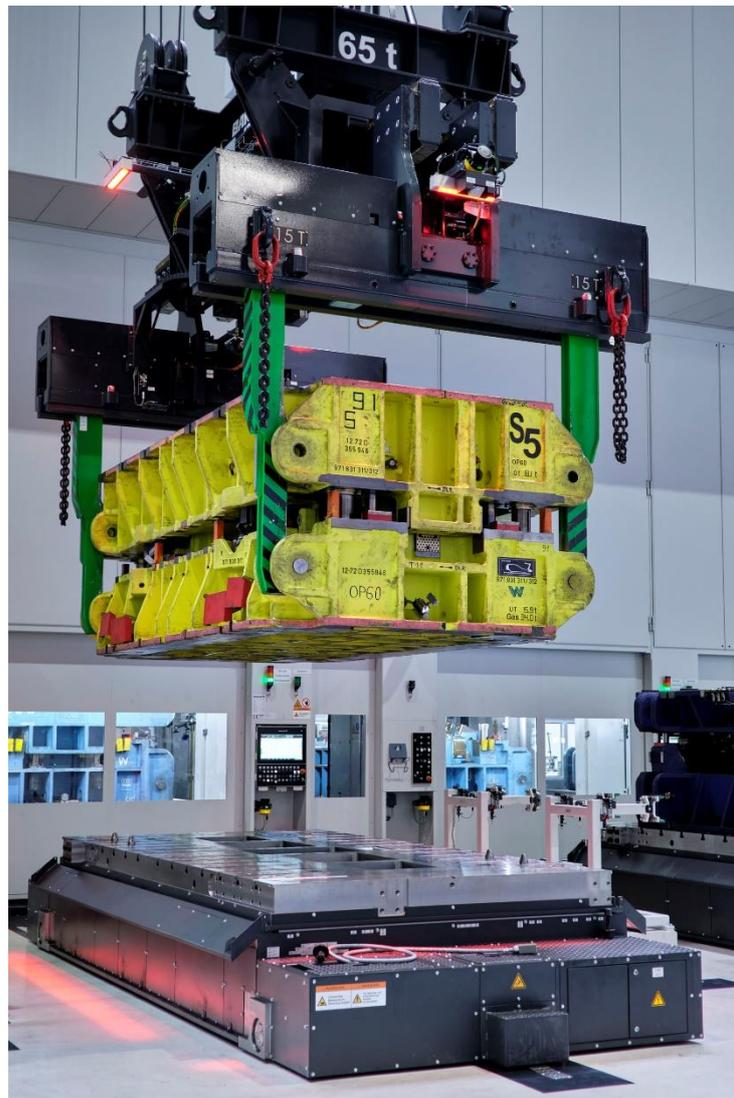
**Bild 3:** Lastaufnahmemittel mit redundantem 3D-Laser und Ultraschall-Sensorik
