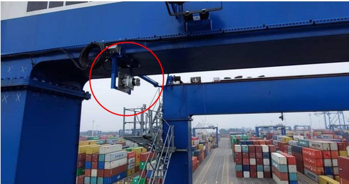
**Bild 3:** LaseASTO installiert am RTG
