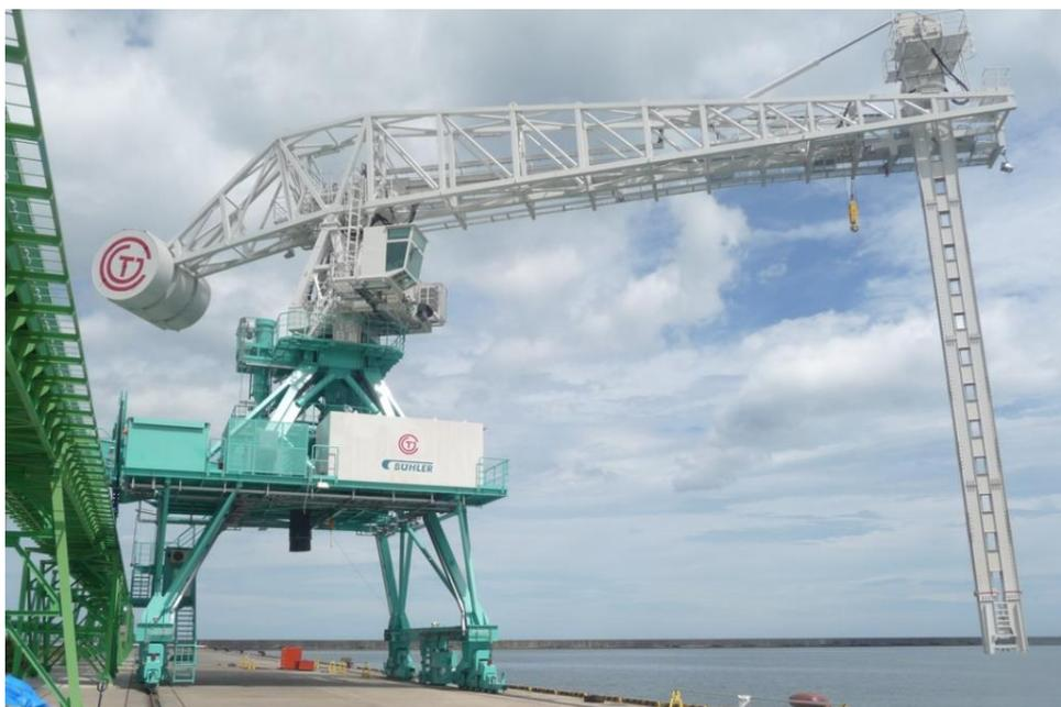
**Bild 1:** Typischer Aufbau eines Schiffsentlader [ Bühler AG Uzwil]
