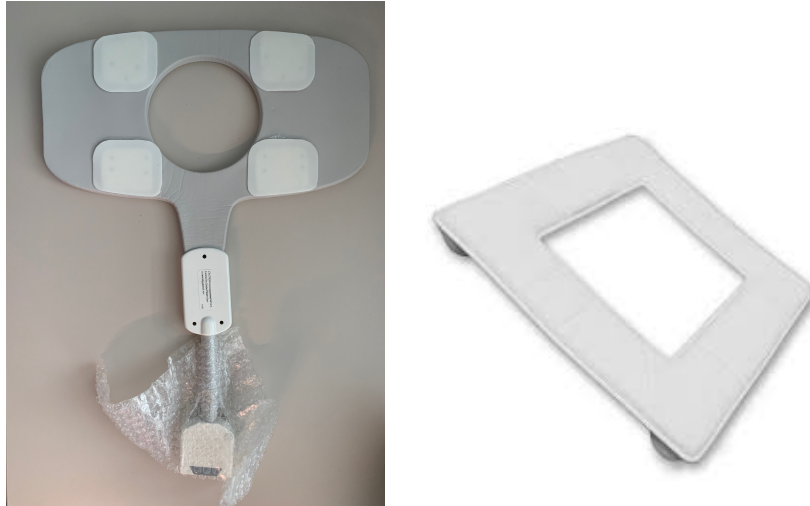
Abbildung 4.1: Im derzeitigen Stand der Technik verfügbare Empfangsspulen zum Einsatz während perkutaner bildgeführter Eingriffe.
