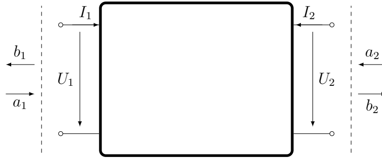
Abbildung A.1: Beliebiger Vierpol mit den aus- und eingehenden Leistungswellen, sowie den Torspannungen und -strömen.
